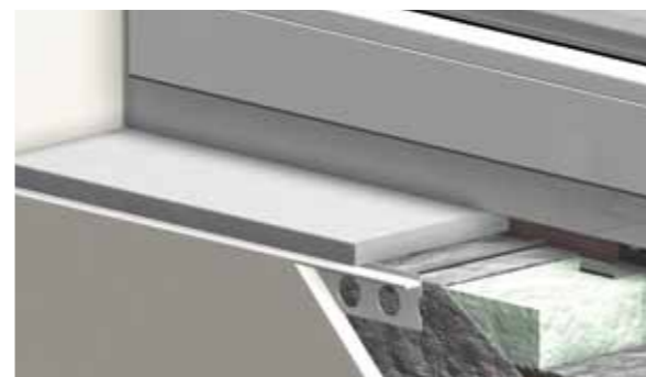
Einbau bei Ziegelparapet mit verputzter Fläche
