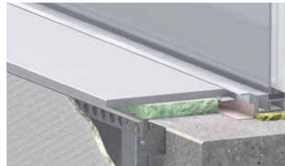
Einbau bei Betonparapet mit Trockenbauvorsatzschale
