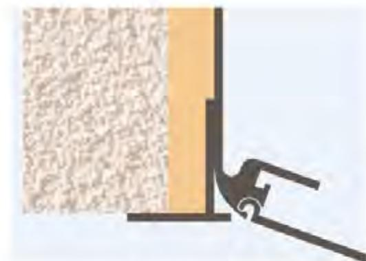
Bei Blendenausführung ohne nach außen gerichteter Putznase, kann das Putzsystem mit Anputzprofilen angeschlossen werden. Dabei sind die Untergründe entsprechend vorzubereiten (z.B. reinigen, primern). Vor Ausführung ist eine Klebprobe erforderlich.
