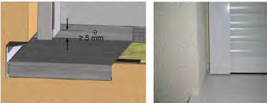
**Abbildung 24:** nachträglich montierte vorgesetzte Sonnenschutzschiene
